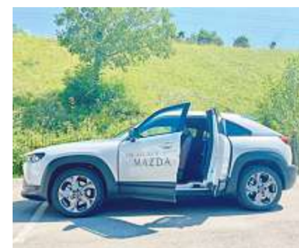
Das MX-30-Türsystem mit gegenläufig öffnender Hintertür.
